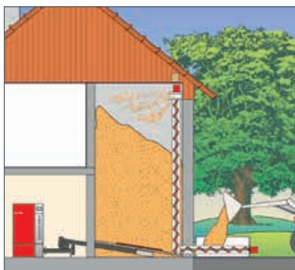
Великий склад тріски на 1-му поверсі з вертикальним шнеком завантаження
