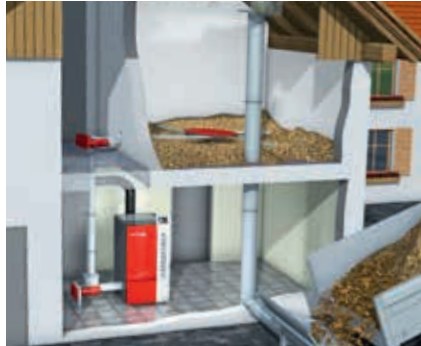
Великий склад тріски на 2-му поверсі з вертикальним шнеком завантаження та спускною трубою.
