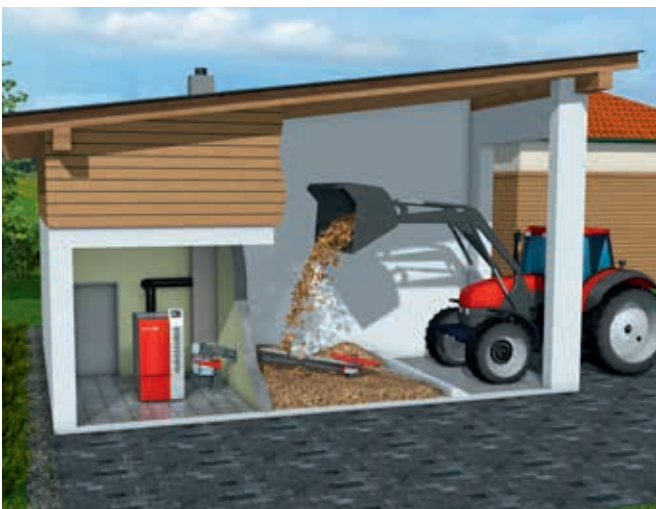
Приміщення топкової та складу неподалік будинку що обігривається
