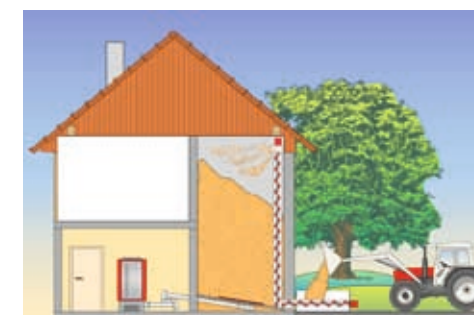
Система загрузки для двухэтажного склада для щепы.
