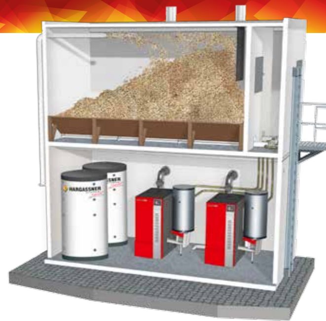
Двоповерхова модульна котельня
